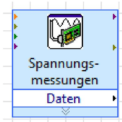
**Abb.7.1.12: Passende Namen verbessern das Verständnis im Blockdiagramm**
