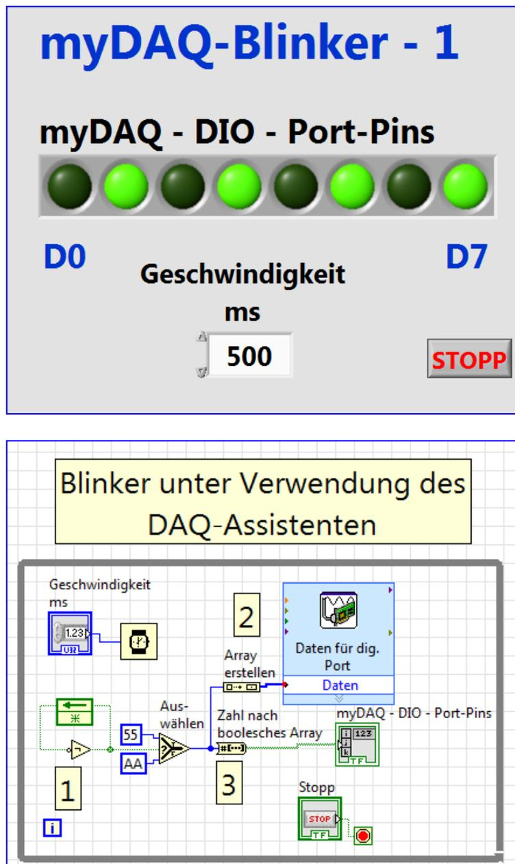
**Abb.8.1.3: Frontpanel und Blockdiagramm des LED-Blinkers ('Blink-1.vi')**
