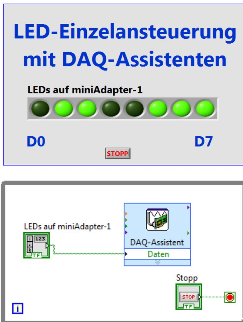
**Abb.8.1.1: Die Einzelsteuerung von LEDs ('LED-Einzel.vi')**
