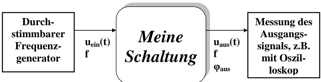
Abb.6.5.1: Die Aufnahme des Frequenzganges
