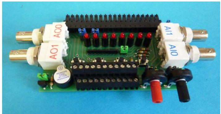
Der erste dieser Adapter aus der ganzen Serie ist die **Experimentieradapterplatine 1**, der das myDAQ-Modul u.a. um acht LEDs, einen Piezo-Summer, vier Taster, zwei Potentiometer, vier BNC-Buchsen und Doppelstock-Klemmblöcke erweitert.
