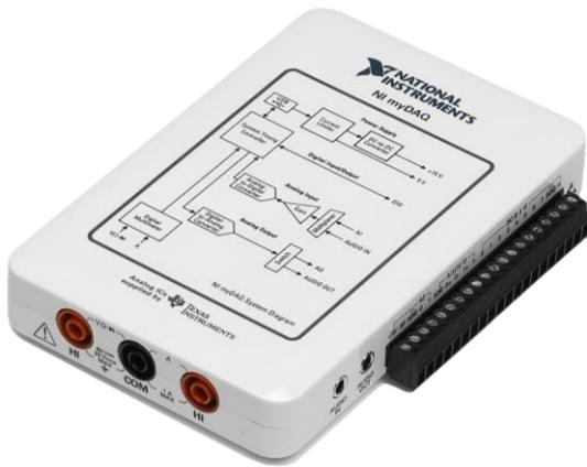
Weitere große Einsatzgebiete ergeben sich durch die Einbindung des myDAQ-Moduls in die grafische Entwicklungsumgebung **LabVIEW**. Mit Hilfe dieser Software kann der Anwender seine eigenen myDAQ-Programme schreiben und individuell seine ganz speziellen Mess- und Analyseaufgaben mit diesem Modul lösen.
