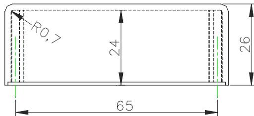
Gehäuseunterteil und Oberteil schwarz mit Befestigungslaschen und innenliegenden Befestigungsmöglichkeiten für Platinen.
