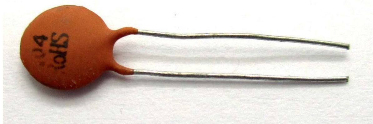
Der Scheibenkondensator mit 100 \text{nF}
