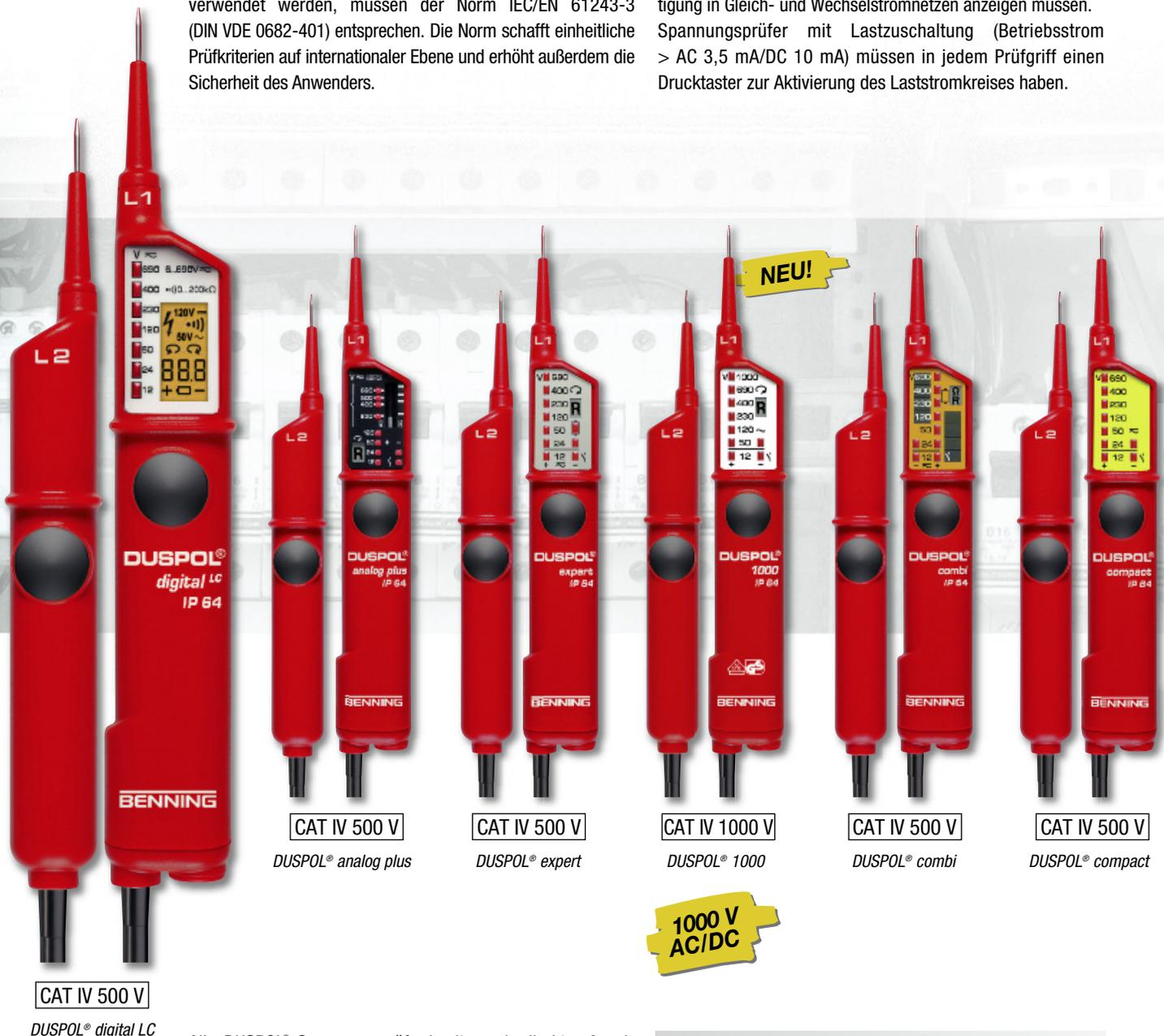
Alle DUSPOL®-Spannungsprüfer besitzen ein direktes Anzeigesystem ohne Belastung der Prüfstelle. Im Bedarfsfall kann ein Lastkreis über Drucktaster zugeschaltet werden, der induktive und kapazitive „Blindspannungen“ unterdrückt. Somit kann eindeutig zwischen energiereichen und energiearmen Stromkreisen unterschieden werden.
