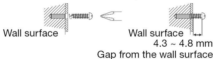
Hängen Sie das Gerät auf die Schrauben.
