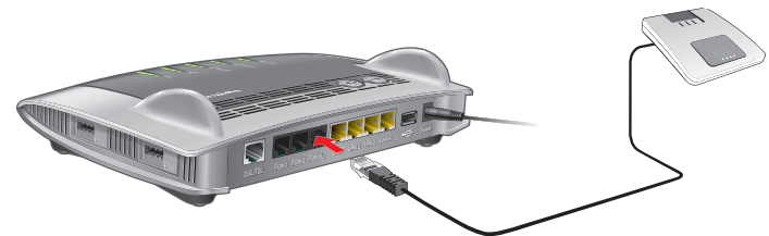
Anschluss einer ISDN-Telefonanlage
