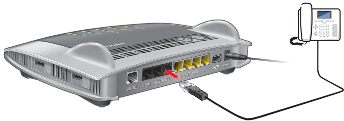
Anschluss eines ISDN-Telefons
