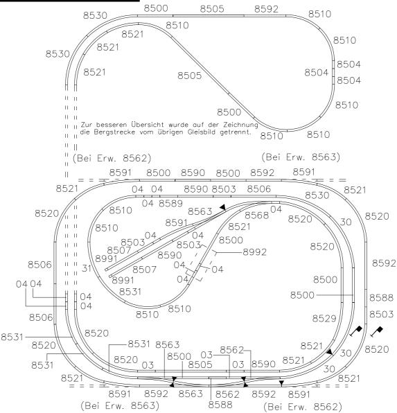
₹ einseitige Trennung durch Trennlaschen Nr. 8954 🛨 beidseitige Trennung durch Trennlaschen Nr. 8954
