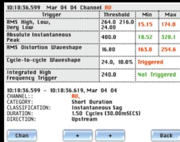
Für noch schnellere Analysen verfügt der MAVOWATT 40 über zusätzliche AnswerModules® sowie intelligente Algorithmen die helfen, Quelle und Ursache von Netzqualitätsproblemen genau auszumachen. Diese Diagnose- und Auswertewerkzeuge basieren auf jahrzehntelanger Erfahrung in Analyse, Bewertung und Fehlersuche. Sie verwandeln Rohdaten in präzise Antworten für eine schnelle Entscheidungsfindung.
