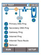
Anzeige des Netzwerkplanes zum Prüfen der Ergebnisse für die einzelnen Netzelemente.
