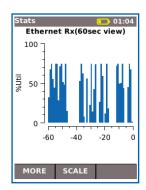
Echtzeit-Anzeige des Verkehrs im Broadcast-Netzwerk in Prozent der Port-Rate der vergangenen 10 Minuten.
