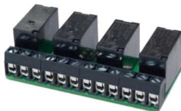
Im Gegensatz zum Hauptrelais sind die Relais auf der Relais Steckkarte im Überwachungsmodus nicht angezogen. Die Karte wird einfach auf die Elektronik des SHT 5000 aufgesteckt.
