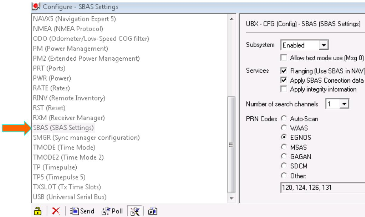
Der NL-8022MU nutzt EGNOS standardmäßig. In der SBAS Konfiguration können Sie diese Einstellung überprüfen und gegebenenfalls ändern. Genauere Infos hierzu entnehmen Sie bitte der aktuellen Dokumentation unter [http://www.u-blox.com/images/downloads/Product\\_Docs/u-Center\\_User\\_Guide\\_\(UBX-13005250\).pdf](http://www.u-blox.com/images/downloads/Product_Docs/u-Center_User_Guide_(UBX-13005250).pdf).
