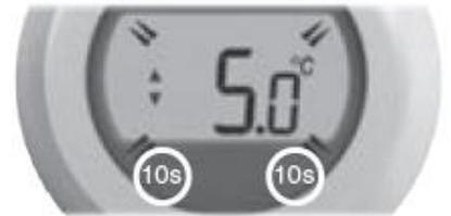
Zwei Sensortasten befinden sich unterhalb des Displays.
