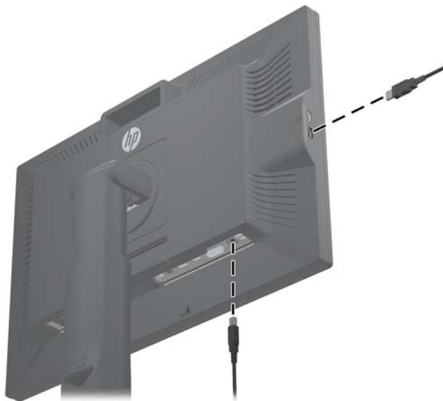
Abbildung 2-11 Anschluss von USB-Kabeln
