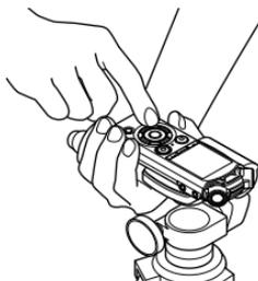
Wenn sich die Befestigungsschraube des Stativs und der Adapter nicht trennen lassen, lösen Sie das in der Abbildung unten dargestellte Teil mithilfe eines Schraubenschlüssels der Größe M10 oder eines anderen Werkzeugs.
