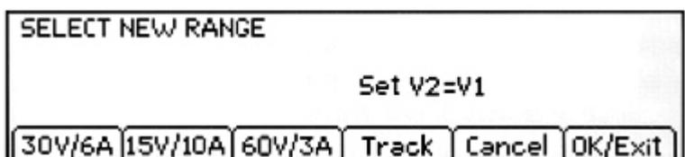
Die Funktion „Voltage Tracking“ kann im Range-Menü auf dem Bildschirm für Ausgang 2 ein- oder ausgeschaltet werden. Alternativ kann es über das System-Menü ausgewählt werden, siehe Abschnitt 9.1.
