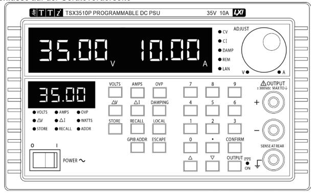
Die Last sollte an die mit OUTPUT (Ausgang) gekennzeichneten positiven (roten) und negativen (schwarzen) Klemmen angelegt werden. Die Ausgangsklemmen (OUTPUT) sind für einen maximalen Strom von 30 A ausgelegt.
