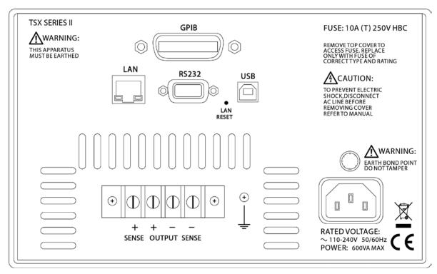
Die Ausgangsklemmen und die Sense-Anschlüsse sind parallel auch auf der Rückseite vorhanden. Diese Anschlüsse sind mit +, -, +SENSE und -SENSE gekennzeichnet.
