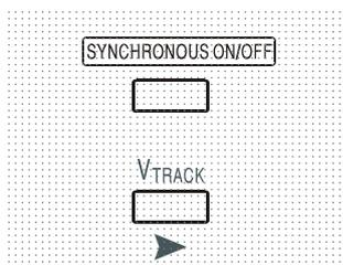
Durch Drücken auf  $V_{\text{TRACK}}$  wird die Tracking-Funktion für die Spannung gewählt. Die beiden Ausgänge bleiben elektrisch getrennt, aber die Spannungsregler von Ausgang 1 (Master) setzen eine identische Spannung an Ausgang 2 (Slave). Die Stromregler von Master und Slave bleiben unabhängig.
