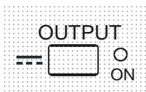
Beim Einschalten ist der Ausgang standardmäßig immer ausgeschaltet. Die Werte für Ausgangsspannung und Strom hängen von den jeweiligen Reglereinstellungen ab und werden auf dem Display angezeigt. Die Lampe VIEW leuchtet, um darauf hinzuweisen, dass es sich bei den angezeigten Werten um die Voreinstellungen handelt. Alle anderen Einstellungen entsprechen dem Zustand vor dem letzten Abschalten des Geräts.
