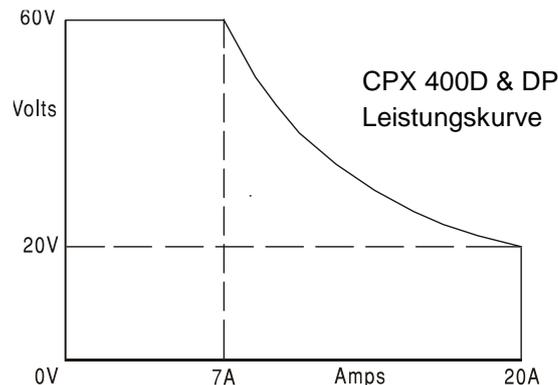
Die Leistungskurve stellt 60V/7A, 42V/10A und 20V / 20A unter allen Umständen bereit (beide Ausgänge unter Last). Bei niedrigeren Ausgangsspannungen ist die Ausgangsleistung auf maximal 20 A begrenzt.
