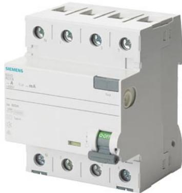
FI-Schutzschalter, 4-polig, Typ A, In: 40 A, 30 mA, Un AC: 400 V, N-links
