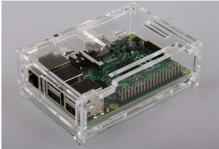
Nachdem Sie das Gehäuse mit eingesetzten Raspberry Pi zusammengebaut haben, setzen Sie die beiliegende microSD-Karte in den entsprechenden Slot an der Unterseite der Platine ein.
