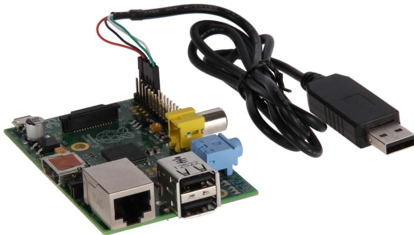
Über die serielle Schnittstelle auf den Pins 8 [TXD] und 10 [RXD] auf dem GPIO-Header des Raspberry Pi, lässt sich somit eine Verbindung zur Terminalkonsole aufbauen und Befehle für das Betriebssystem eingeben, ohne dass eine Verbindung per Netzwerk aufgebaut oder ein Bildschirm per HDMI angeschlossen werden muss.
