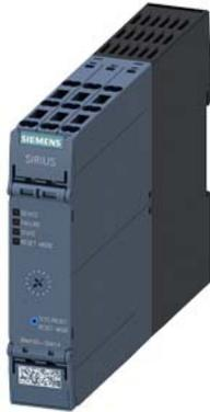
Direktstarter, 3RM1, 500 V, 0,55 - 3 kW, 1,6 - 7 A, AC 110-230 V, Schraub-/Federzuganschluss
