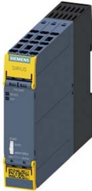
SIRIUS Sicherheitsschaltgerät Grundgerät Standard Reihe Relais-Freigabekreise 3 Schließer plus Relais-Meldekreis 1 Öffner  $U_s = 110 - 240$  V AC/DC 50/60 Hz Federzuganschluss (Push-In)
