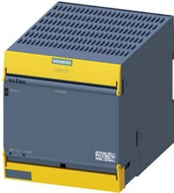
SIRIUS Sicherheitsschaltgerät Ausgangserweiterung 3RO Power, mit Relais-Freigabekreisen 3 Schließer plus Relais-Meldekreis 1 Öffner Us = 115 V AC Schraubanschluss
