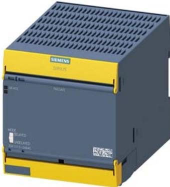
SIRIUS Sicherheitsschaltgerät Ausgangserweiterung 3RO Power, mit Relais-Freigabekreisen 3 Schließer plus Relais-Meldekreis 1 Öffner Us = 24 V DC Federzuganschluss (Push-In)
