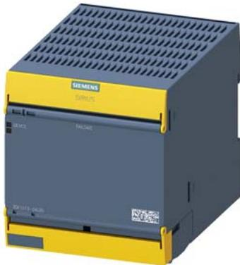
SIRIUS Sicherheitsschaltgerät Ausgangserweiterung 3RO Power, mit Relais-Freigabekreisen 3 Schließer plus Relais-Meldekreis 1 Öffner Us = 230 V AC Federzuganschluss (Push-In)
