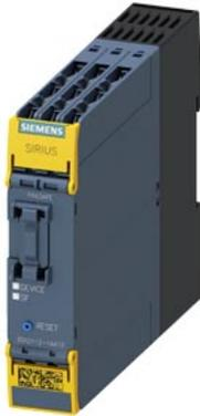
SIRIUS Sicherheitsschaltgerät Grundgerät 3SK2 Reihe 10 F-DI, 2 F-DQ, 1 DQ, 24 V DC parametrierbar über SIRIUS Safety ES 22,5 mm Baubreite Schraubanschluss bis SILCL 3 (DIN EN 62061) bis Performance Level E (ISO 13849-1) Ausgangserweiterungen 3SK1 und fehlersichere Motorstarter 3RM1 über Geräteverbinder anschließbar
