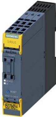
SIRIUS Sicherheitsschaltgerät Grundgerät 3SK2 Reihe 10 F-DI, 2 F-DQ, 1 DQ, 24 V DC parametrierbar über SIRIUS Safety ES 22,5 mm Baubreite Federzuganschluss (Push-In) bis SILCL 3 (DIN EN 62061) bis Performance Level E (ISO 13849-1) Ausgangserweiterungen 3SK1 und fehlersichere Motorstarter 3RM1 über Geräteverbinder anschließbar
