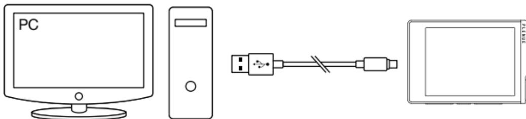
1. Mit dem Micro USB-Kabel wird eine Verbindung zwischen PC und Micro USB-Anschluss hergestellt.
