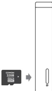
1. Die microSD-Karte, wie in der Abbildung dargestellt, richtig in den microSD-Kartenschlitz einlegen. Die Karte zum Einsetzen leicht drücken.
