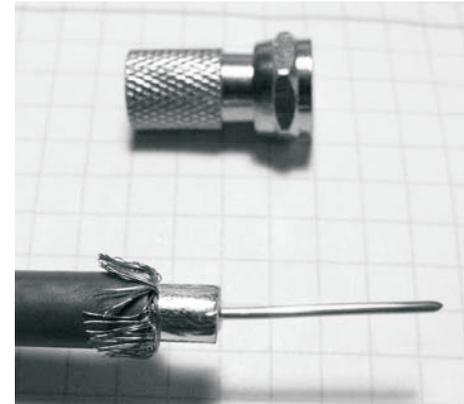
3. F-Stecker auf das Koaxialkabel einschrauben bis ...
