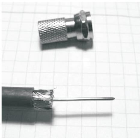
1. Koaxialkabel abisolieren:
