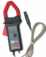
Stromzange C-5A (Ø 39 mm) 1000 A AC/DC
