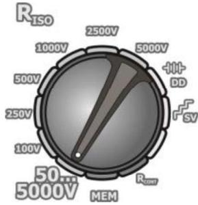
Der Drehschalter zur Funktionsauswahl sollte auf einer der Positionen eingestellt werden  $R_{ISO}$ , mit gleichzeitiger Auswahl der Messspannung (Position **50...5000V** alle 10V in dem Bereich gewählt 50 V...1 kV je 10 V, 1 kV...5 kV je 25 V). Das Messgerät befindet sich im Modus zur Spannungsmessung.
