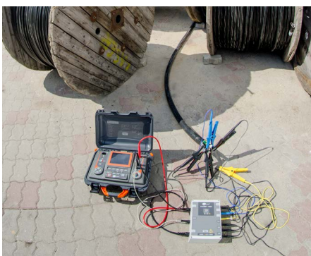
Mehradrige Messungen durch ein nur einmaliges anschließen
