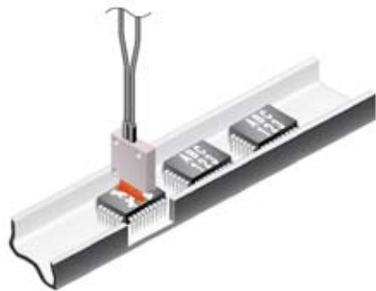
Qualitative Überprüfung von Aufdrucken (FD-AFM2)
