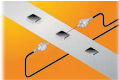
Erkennen von ICs in Umgebung hoher Temperatur (bis 200°C) bei Biegeradien bis zu 10mm (FT-H20W)
