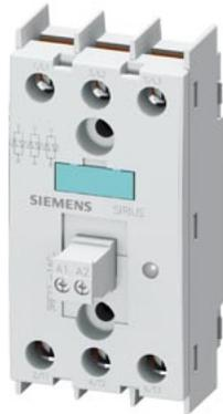
Halbleiterrelais, 3-phasig 3RF2 55 A / 40 °C 48-600 V / DC 4-30 V 3-Phasengesteuert Schraubanschluss Sperrspannung 1200 V
