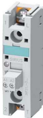
Halbleiterrelais, 1-phasig 3RF2 Baubreite 22,5 mm, 50 A 48-460 V / 110-230 V AC Ringkabelanschluss
