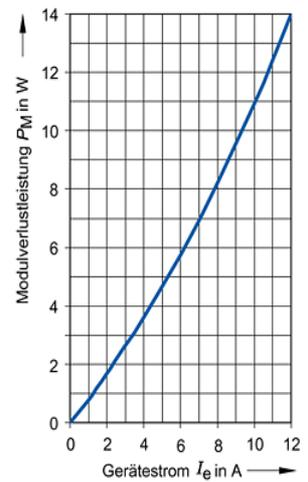
—  $I_{max}$  Thermischer Grenzstrom bei Dicht-an-Dicht-Montage
