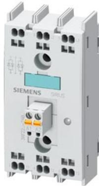
Halbleiterrelais, 3-phasig 3RF2 55 A / 40 °C 48-600 V / DC 4-30 V 2-Phasengesteuert Federzuganschluss Sperrspannung 1200 V
