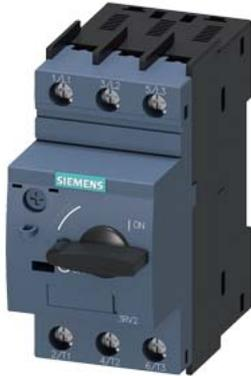
Leistungsschalter Baugröße S00 für den Motorschutz, CLASS 10 A-Auslöser 7...10 A N-Auslöser 130 A Schraubanschluss Standardschaltvermögen
