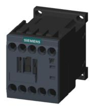
Leistungsschütz, AC-3 7 A, 3 kW / 400 V 1 Ö, AC 230 V, 50 / 60 Hz 3-polig, Baugröße S00 Schraubanschluss
