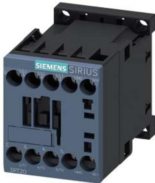
Leistungsschütz, AC-3 7 A, 3 kW / 400 V 1 S, DC 24 V 3-polig, Baugröße S00 Schraubanschluss
