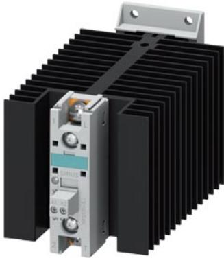
Halbleiterschütz 1-phasig 3RF2 AC 15 / 27,5 A / 40 °C 48-600 V / DC 24 V momentanschaltend Seit 21.5.2018 haben sich die Abmessungen und das Bohrbild geändert, weitere Info im Industry Online Support
