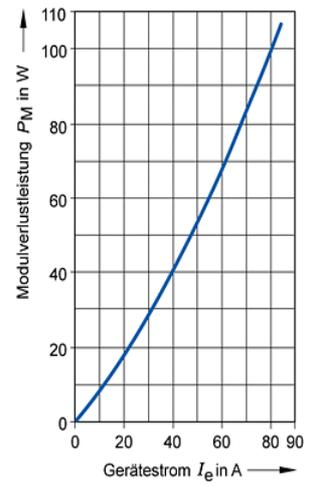
—  $I_{\max}$  Thermischer Grenzstrom bei Einzelaufstellung
