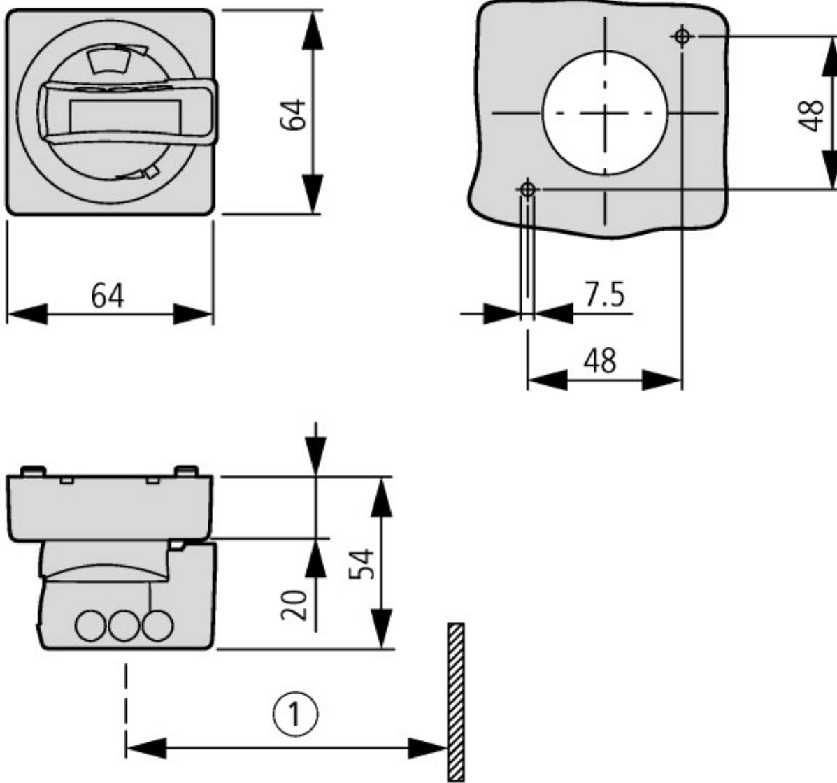
Einbautiefe: 125 bis 240 mm von der Oberkante DIN-Hutschchiene bis Vorderkante Schranktür/Deckel
