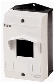
Isolierstoffgehäuse CI-K2, H x B x T = 160 x 100 x 104 mm, für PKZ0, + Ausschnitt 45 mm, IP40
