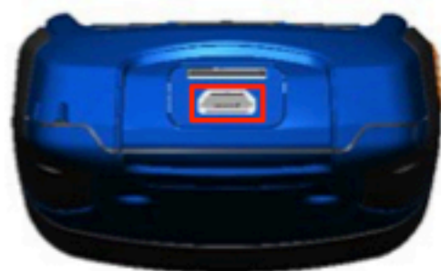
Abbildung 44: Reveal mit geöffneter Rückklappe und markiertem USB-Port (für die Verbindung).
