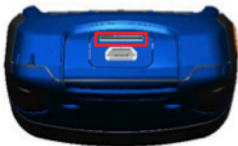
Abbildung 41: Reveal mit geöffneter Rückklappe und markiertem microSD-Karten-Steckplatz.
