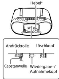
\* Sie erhalten Zugang zum Löschkopf, indem Sie die Aufnahmetaste ([5]) drücken, während Sie den Hebel mit dem Finger gedrückt halten.
