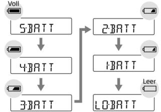
Nachdem die Warnung „LO-BATT“ 8 Sekunden lang geblinkt hat, schaltet sich das Gerät automatisch aus.
