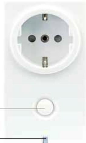
Das Gerät kann für elektrische Verbraucher, wie HV-, NV-Halogenlampen, Leuchtstofflampen und Glühlampen, mit einer Schaltleistung bis 3500 W eingesetzt werden. Die Bedienung kann wahlweise via Funk über einen Controller (Funk-Fernbedienung / -Wandschalter) oder direkt über die Taste am Funk-Zwischenstecker erfolgen. Der Schaltzustand wird über eine rote LED im Taster angezeigt.
