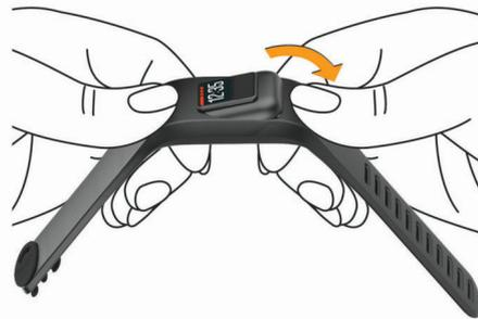
2 Setzen Sie das Gerät in das flexible Silikonband ein. Dabei müssen Sie das Band ein wenig ziehen und formen, bis es um das Gerät passt.
