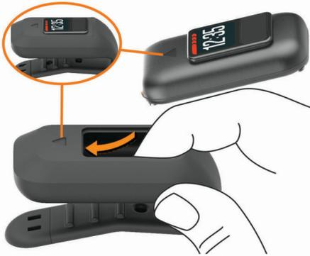
Entfernen Sie das Gerät aus dem Gürtelclip, indem Sie das flexible Material des Clips vom Gerät lösen.
