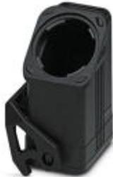
HEAVYCON EVO-Kupplungsgehäuse aus Kunststoff, mit Bajonettflansch für die EVO-Verschraubung, B6, mit Längsbügel, Höhe 90 mm, ohne EVO-Verschraubung
