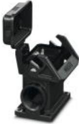
Sockelgehäuse B10, mit Längsbügel, Material: Polyamid, Material Schutzdeckel: Polyamid, Kabelabgänge: 2, seitlich, Höhe: 74 mm, Kabelverschraubung: ohne, Stutzen: nein, 2x M32, Schutzdeckel: ja, Standard
